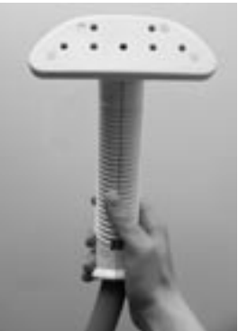
Boquilla con chorros de vapor de alta velocidad
