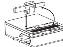
**Enchufe australiano (Australia, China, Islas Fiyi y Nueva Zelanda)** – Presione suavemente el botón y deslícelo completamente hacia la izquierda hasta que las patas planas salgan. Posicione las patas en “/ \”. Extraiga la pata de plástico de la cavidad lateral e introdúzcala como se muestra.
