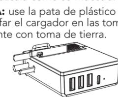
**NOTA:** use la pata de plástico para enchufar el cargador en las tomas de corriente con toma de tierra.
